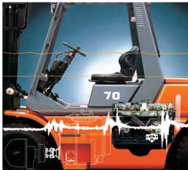
В конструкции погрузчиков серии 5 используется специальная система подвески двигателя, в значительной мере уменьшающая передачу вибрации двигателя на раму. Это повышает не только комфорт для оператора, но и долговечность рамы. В компании Toyota передовые технологии идут рука об руку с повышением комфорта. Действует концепция ТЕХНОЛОГИЧЕСКОГО КОМФОРТА, идея которой состоит в том, что эффект непрерывного развития наших технологий должен в конечном итоге сказываться на условиях работы оператора.
